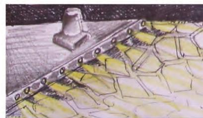
La strada su cui sta camminando l'osservatore si illumina per mezzo di un interruttore ad infrarossi posto a lato del plastico, all'estremità della stanza intorno al miliario è stato creato un pavimento flottante che oltre a facilitare il passaggio dei cavi elettrici ha permesso l'installazione di faretti a led lungo tutto il perimetro del pavimento rialzato.
