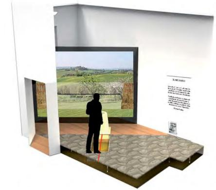
Il sensore laser al passaggio dell'utente cambia l'ambientazione proiettata sullo schermo.
